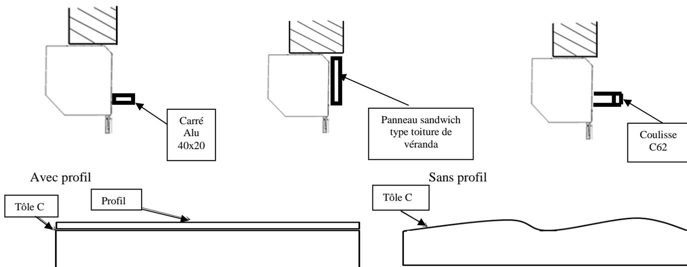
**Dans le cas d'une pose en applique avec un enroulement extérieur, afin de faciliter le passage du boîtier de sécurité anti-écrasement, nous préconisons de ne pas serrer les vis du haut des coulisses et du caisson à fond mais de le faire ultérieurement.**
