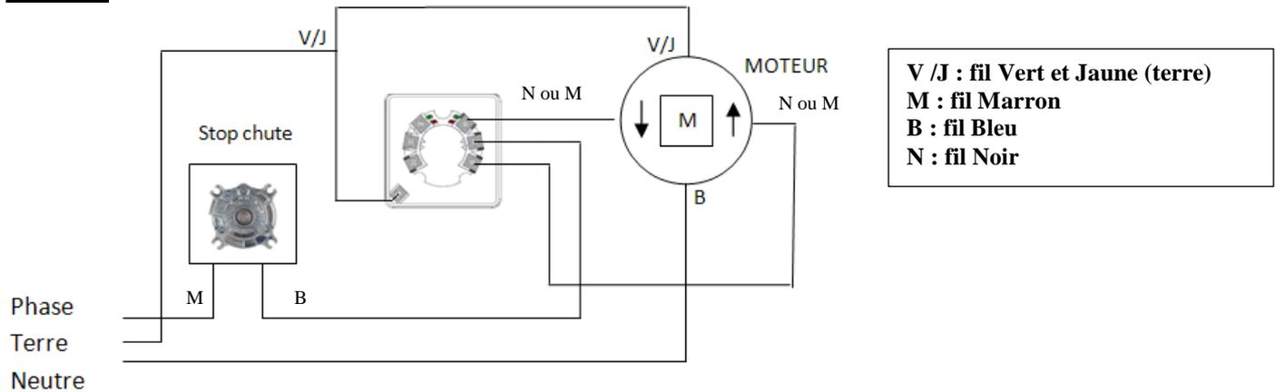
Si la commande « Montée » effectuée une « Descente », il faut inverser les fils Marron et Noir (hors tension)
