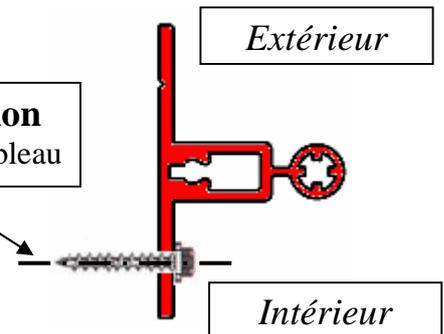
5) Mettre en place les arrêts et les butées en glissant les supports dans les rainures des traverses sur la face extérieure de la persienne.
